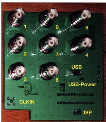
Bild 1: Vorderseite des universellen Taktgenerators mit den BNC-Buchsen der Taktausgänge und dem stehenden USB-Anschluss
