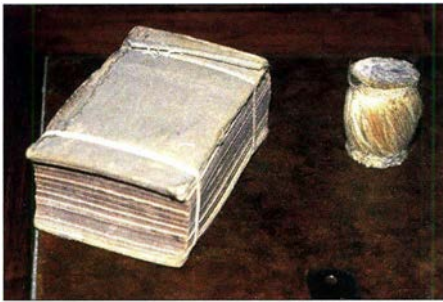
Polarisator aus einem Buch mit in die Seiten eingelegeten Aluminiumfolienblättern; später entdeckte Bose, dass bereits die Seiten ohne Folie mit den Luftspalten dazwischen als Polarisator wirkten. Rechts daneben befindet sich ein Polarisator aus verdrehter Jute.
