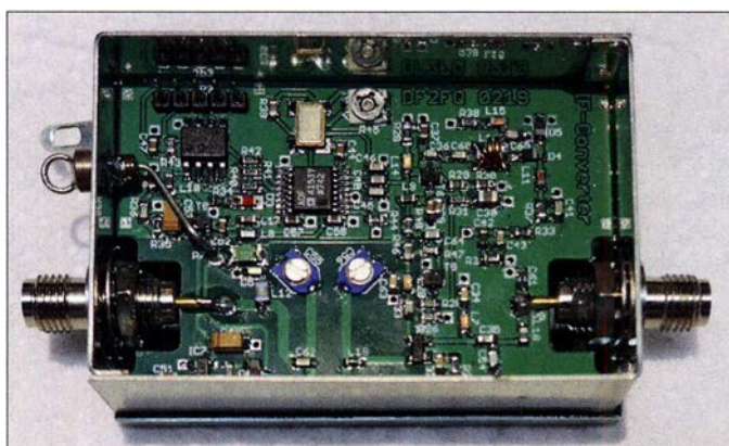
Bild 12: Vollständig aufgebaute Empfangskonverter im Weißblechgehäuse, hier mit abgenommenem Deckel
