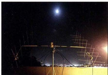
Die auf den Mond ausgerichteten zwei 8x8-Element-DK7ZBs bei EF9LZ; im Hintergrund die Lichter Ceutas Foto: DH7FB
