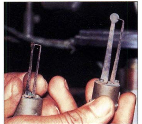
Zwei von Boses Punktkontakt-detektoren, die aus Empfangsantennen ausgebaut wurden
