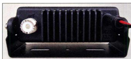
Die Kühlung erfolgt passiv über Kühlrippen.
