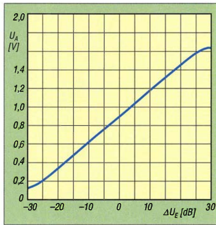
Bild 8: Spannung am Pin VMAG in Abhängigkeit von der Differenz der Eingangssignale \Delta U_E
