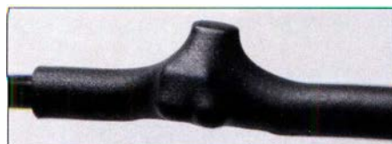
Bild 6: Der Spannungsregler einschließlich Peripherie wurde ins Kabel integriert und mit Schrumpfschlauch überzogen.
