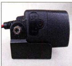
Hinter einer Abdeckklappe befinden sich zwei Klinkenbuchsen in Kenwood-Belegung zum Anschluss anderer Mikrofone oder Lautsprecher.
