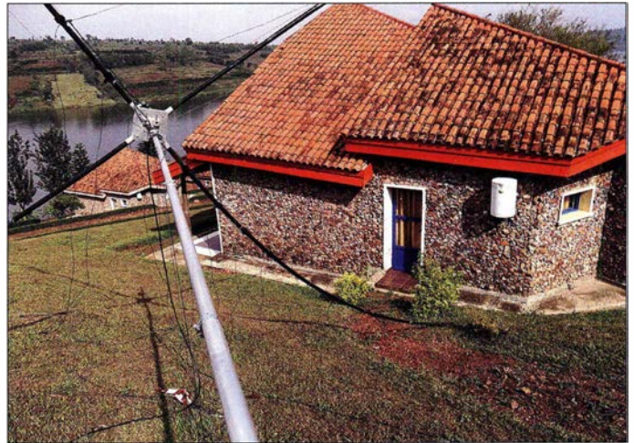
Bei einem Sturz beschädigter Spiderbeam
