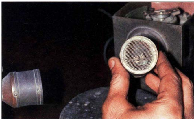
Eine von Boses Sendeantennen; die Funkenstrecke ist hinter dem Polarisationsgitter, dahinter die Hochspannungserzeugung. Links im Bild ist das Empfangshorn zu sehen.
